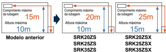
Devido ao aumento do comprimento das tubagens é possível instalar um equipamento num edifício de três andares.
