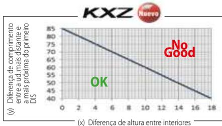
Nota: a diferença de comprimentos entre a unidade mais distante e a mais próxima do primeiro distribuidor, depende da diferença de alturas entre elas. Maquinas situadas no mesmo piso podem chegar a uma diferença de 85m.
