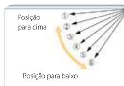
Tem a possibilidade de seleccionar o ângulo desejado do fluxo de ar entre o limite superior e o inferior. Função disponível para os modelos: FDT, FDTC, FDTS, FDK, FDEN e FDFW
