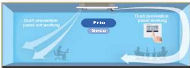
Funcionamento com painel com flaps duplos
