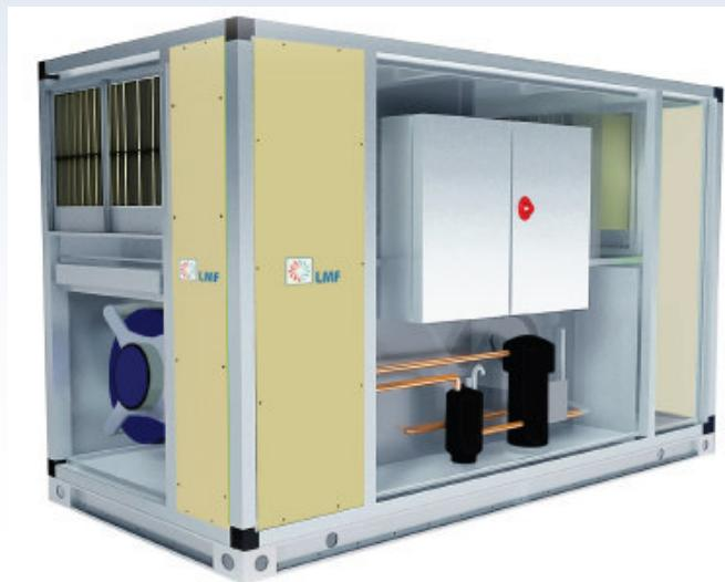
**Unità di recupero di calore ad altissima efficienza con by-pass e circuito frigorifero integrato in pompa di calore con compressori ad inverter**
