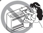
No toque las aletas de aluminio del intercambiador de calor. Apóyese firmemente en una escalera o en algún otro objeto estable al extraer el filtro y el panel de entrada.
