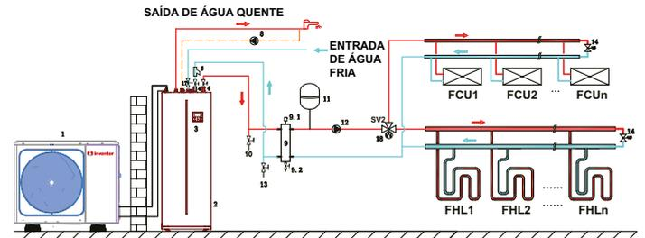
Uma zona para aquecimento por pavimento radiante e ventilo-convetores
