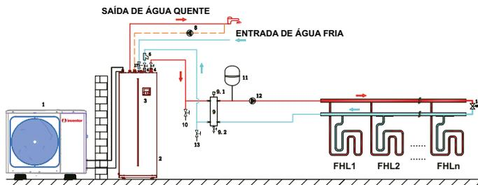
Uma zona para aquecimento por pavimento radiante
