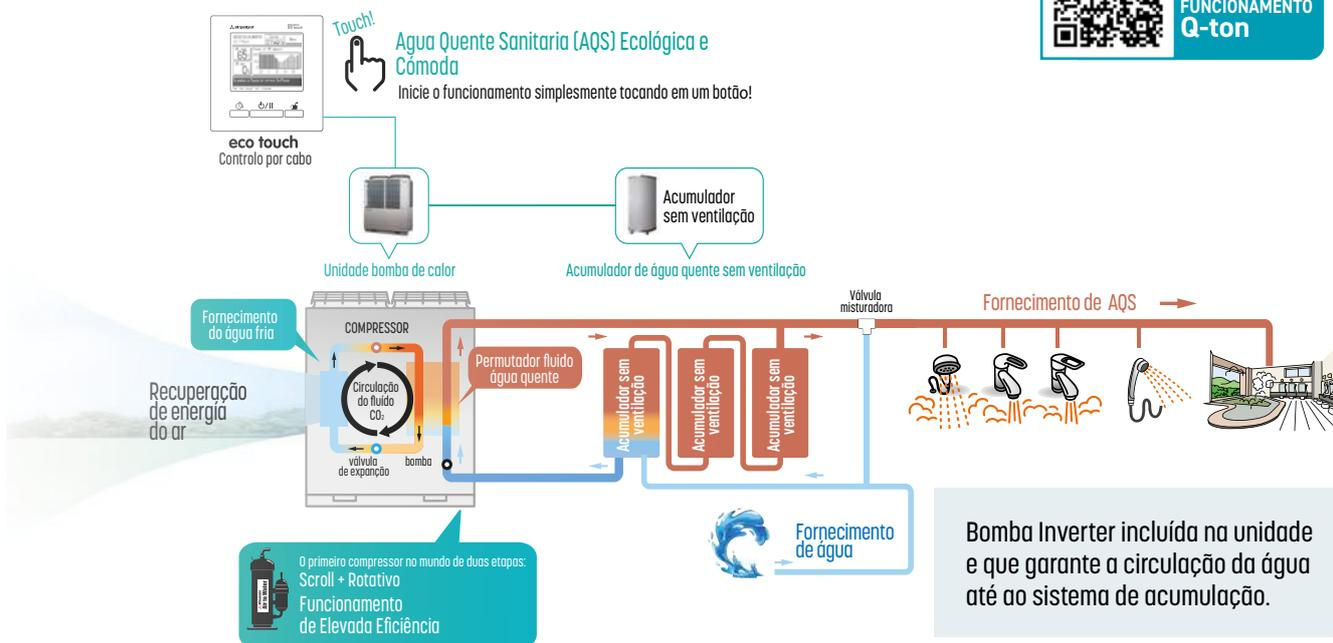
1. A unidade exterior absorve a energia calorífica do ar exterior (fonte de calor), aumenta-a através do compressor, mediante um processo de compressão.
